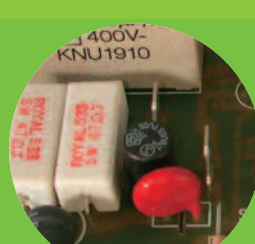
Ochrona bezpiecznikowa przeciw przepięciom
