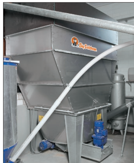
Dozownik CCM zainstalowany w kuchni paszowej
