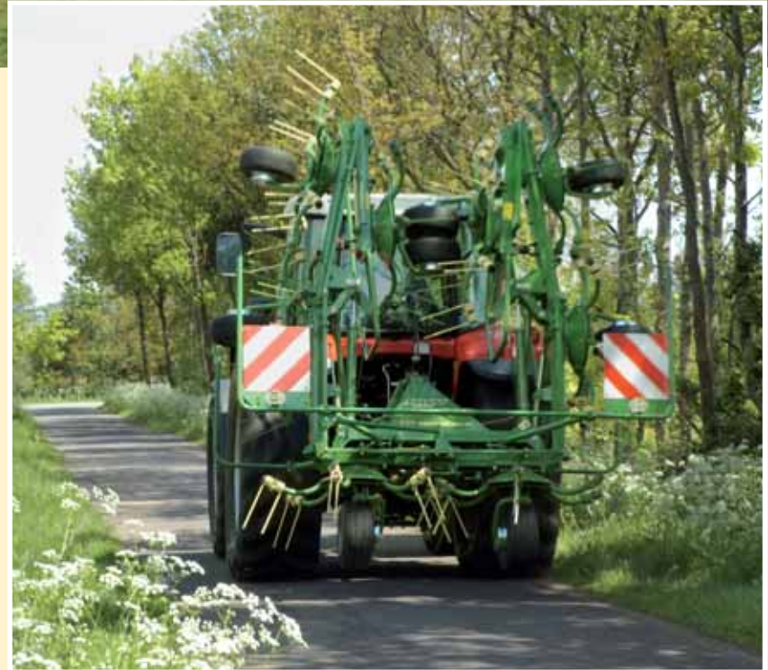
Zwarty układ podczas transportu: KW 8.82/8 można złożyć uzyskując wysokość tylko 3,45 m. Przy szerokości transportowej wynoszącej tylko 2,85 m można bezpiecznie poruszać się po drodze.
