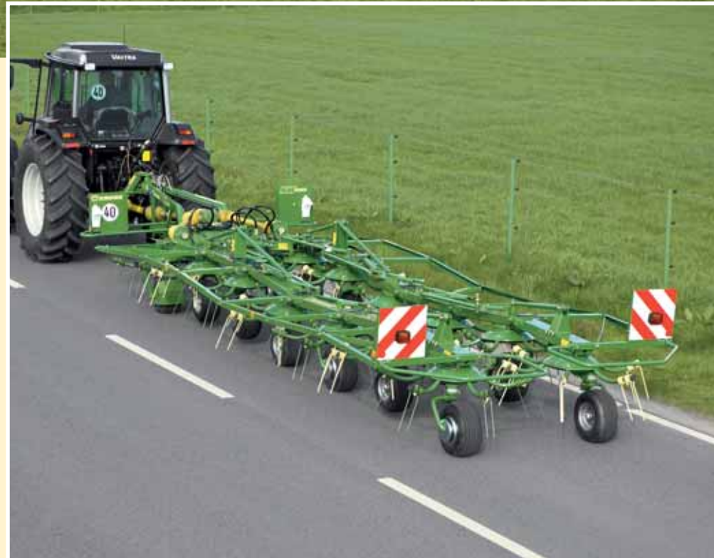
Bezpieczna jazda z prędkością 40 km/h na drodze: przy szerokości transportowej tylko 2,88 m przejeżdża się wszędzie. Oświetlone tablice ostrzegawcze stanowią wyposażenie seryjne.
