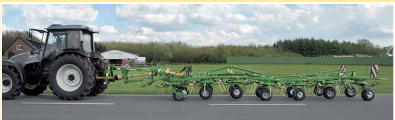
Bezpieczna jazda z prędkością 40 km/h na drodze: przy szerokości transportowej tylko 2,88 m przejeżdża się wszędzie. Oświetlone tablice ostrzegawcze stanowią wyposażenie seryjne.
