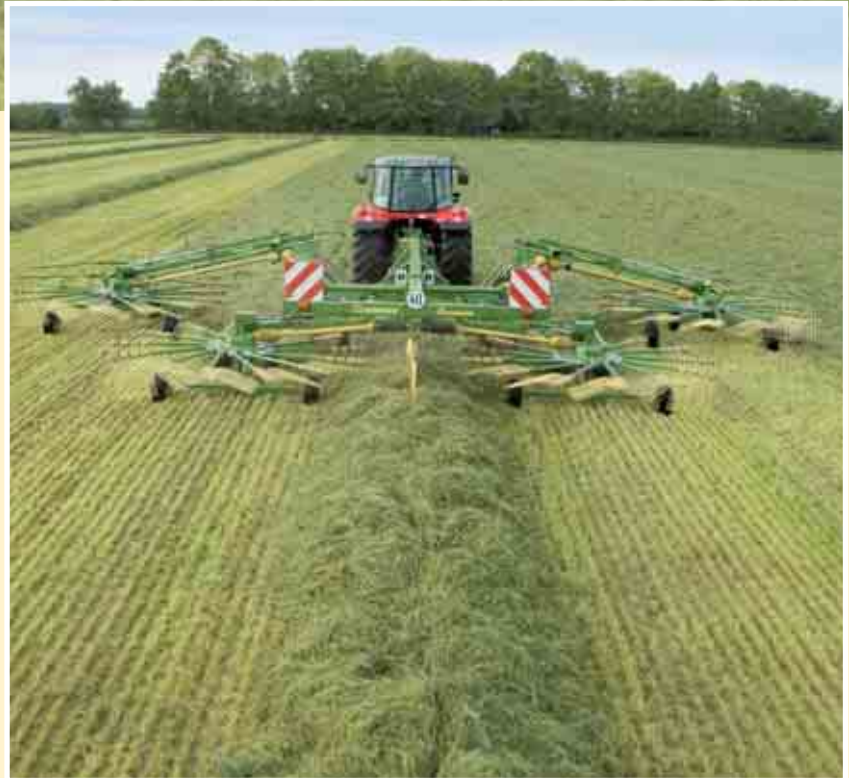
Idealny wał pokosu: w Swadro 1400 prędkości obwodowe przednich wirników są większe niż tylnych. To dostosowanie prędkości obwodowych jest innowacją firmy KRONE, która zapewnia uzyskanie równomiernego i luźno ułożonego wału pokosu.
