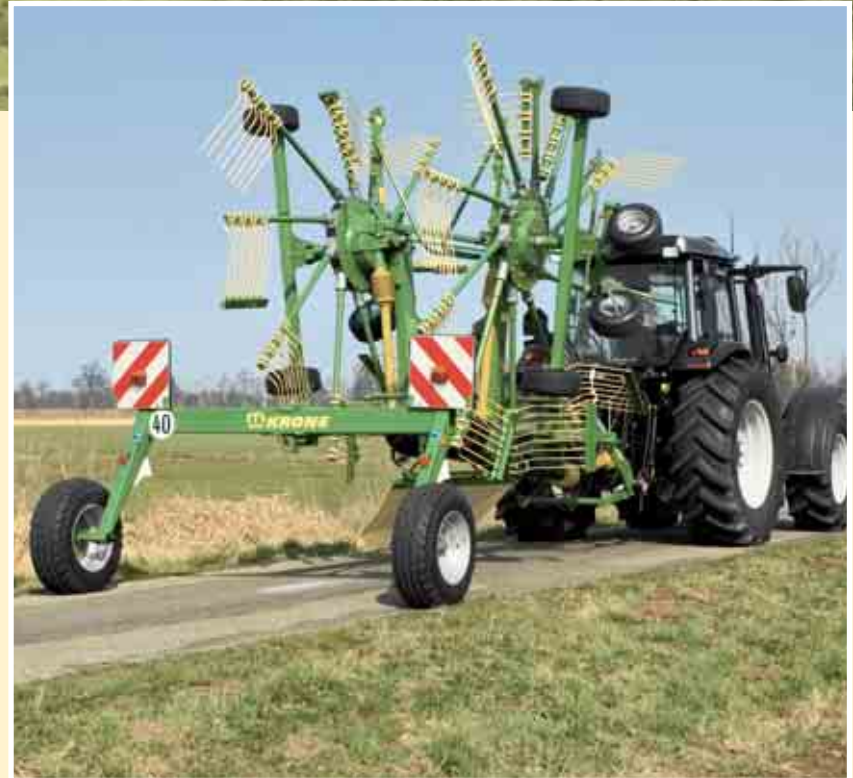
Podwozia o dużym rozstawie kół i dużych oponach 10.0/75 – 15.3/8PR jest przystosowane do maks. prędkości jazdy 40 km/h i zapewnia duże bezpieczeństwo przy szybkiej jeździe.
