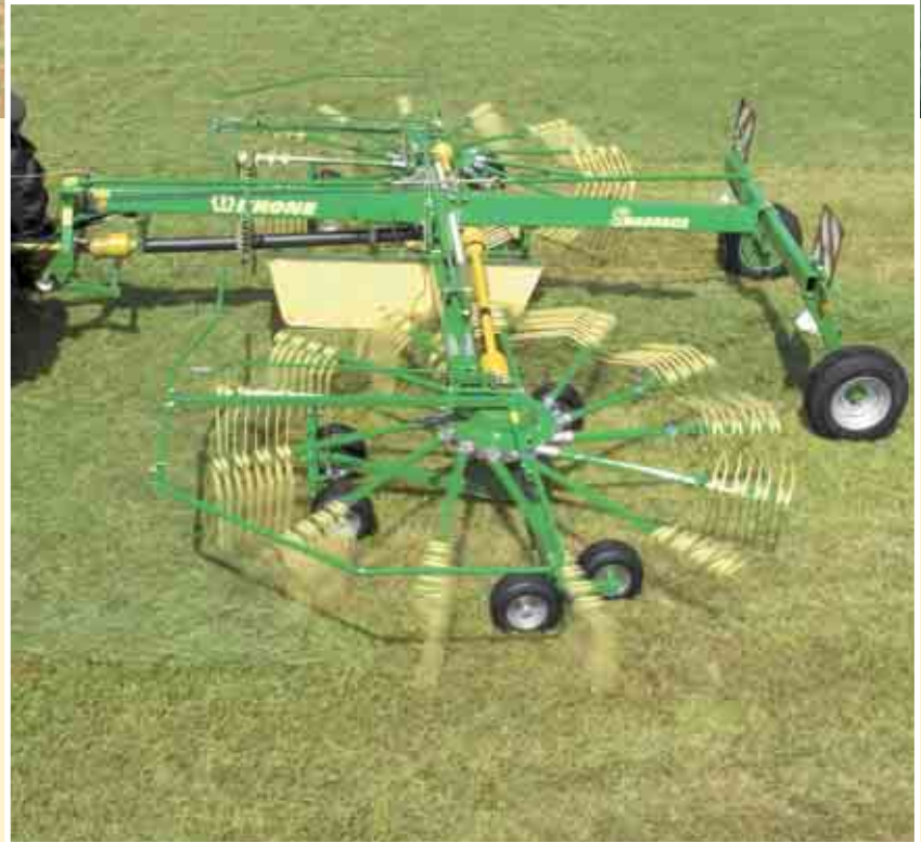
Dokładne zgrabianie: ponieważ zielonka jest „chwytana” tylko przez 1 wirnik. Zgrabarki 2-wirnikowe KRONE typoszeregu SWADRO układają wały z napowietrzonej, luźnej zielonki, o nie skręconych łodygach.
