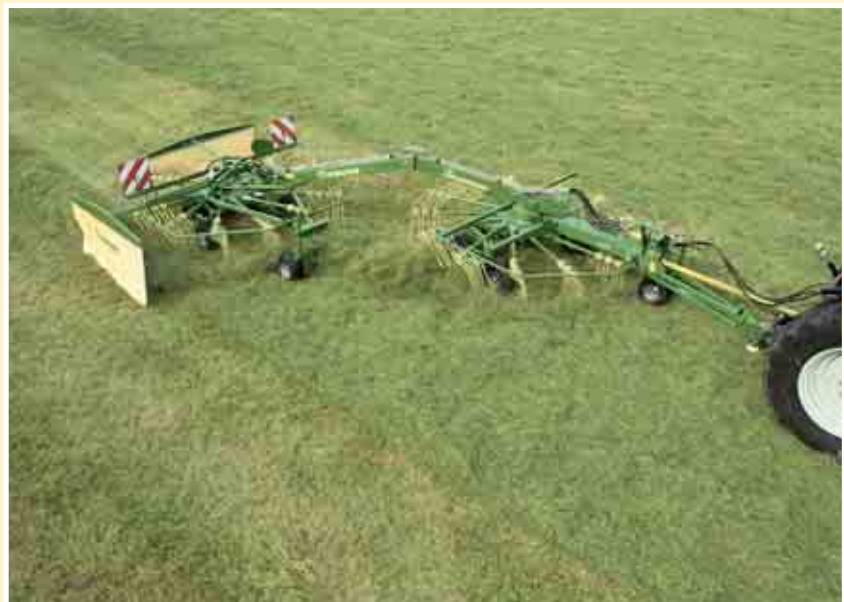
Perfekcyjnie – przy układaniu wału pokosu z prawej strony. Ponieważ elementy obsługi w kabinie ciągnika są umieszczone również po prawej stronie, więc zgrabiarka zapewnia najwyższy komfort jazdy.
