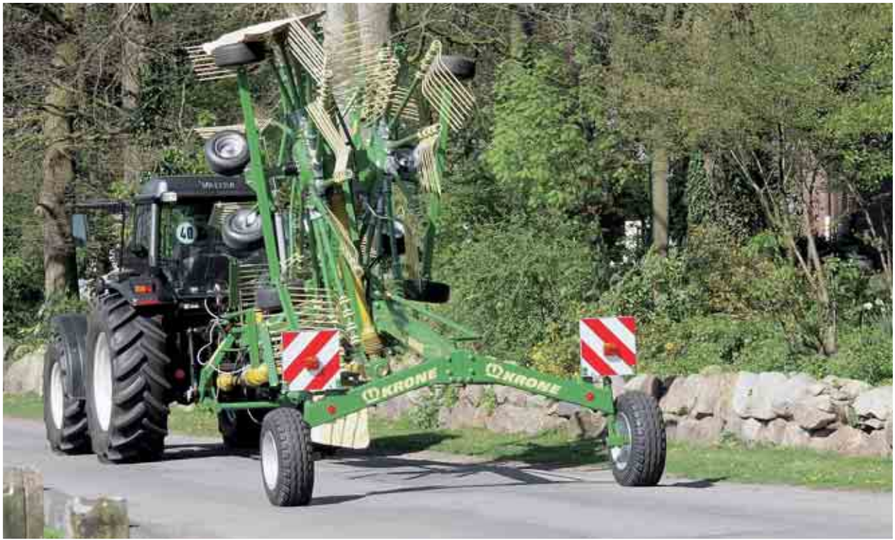
Zwarta i bezpieczna na drodze przy prędkości 40 km/h: przy przejeździe pod niskimi mostami i wjazdami do bram, przewodami i gałziami można złożyć górne lub zewnętrzne ramiona pałców.
