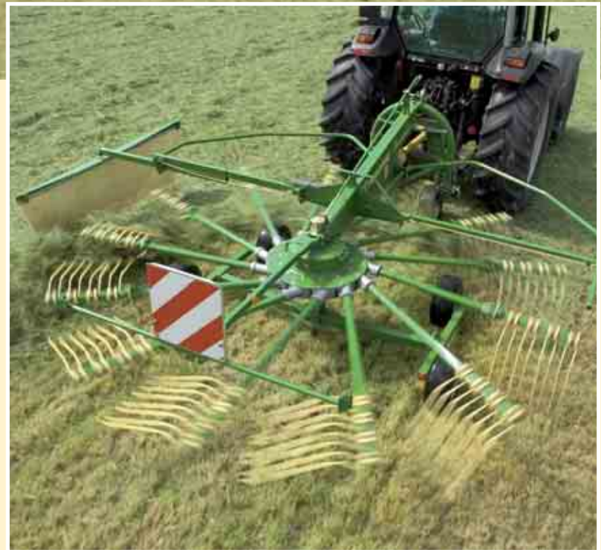
Perfekcyjna praca: zgrabiarki 1-wirnikowe SWADRO 35 do 46 posiadające do 13 stycznie rozstawionych ramion palców, zgrabiają materiał dokładnie w równomierne wały. Nic nie pozostaje na polu.
