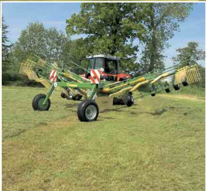
Na uwrociu: traktorzysta może szybko podnieść wirniki nie opuszczając swojego stanowiska
