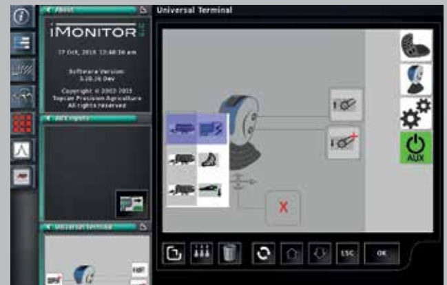
Terminal wirtualny VT4. Podpisywanie funkcji maszyny pod sterowniki na joystickach ciągnika.
