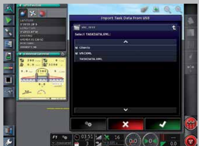
Dzięki standardowi ISOXML, zadania można zaplanować, udokumentować i przeanalizować na podstawie wielu wprowadzonych danych.
