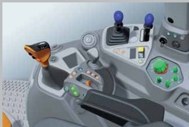
Przekładnia Powershift. Manualna zmiana biegów i półbiegów.
