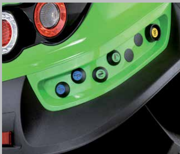
Łatwe w obsłudze przyrządy sterowania hydrauliką zewnętrzną, tylnym podnośnikiem i WOM z każdej strony.
