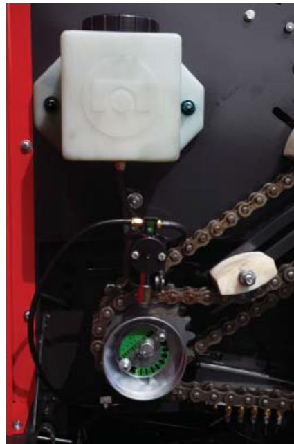
Rys. 26. Centralny układ smarowania.
