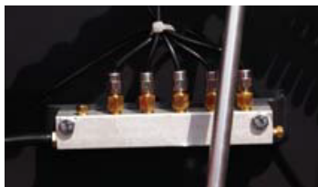
Rys. 27. Centralny układ smarowania - rozdzielacz.
