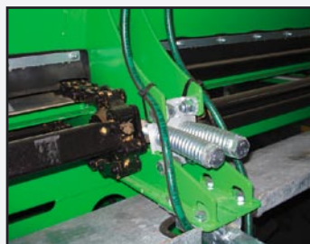
Zewnętrzna regulacja naprężenia łańcuchów
