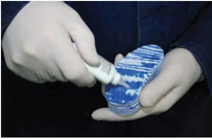
Rys. 3 Nałożyć klej na klocek ciętymi ruchami obok siebie
