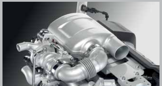
Układ z katalizatorem DOC. Spełnia wymogi normy emisji spalin Euro3b / Tier 4 interim bez konieczności stosowania dodatkowych środków lub obsługi.
