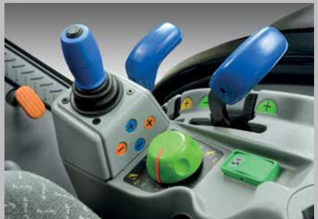
Pokrętło sterowania tylnego podnośnika elektronicznego EHR. Joystick do sterowania 2 obwołów hydrauliki.
