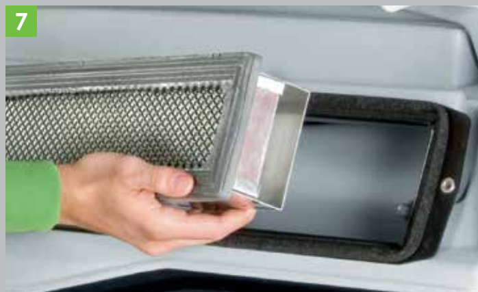
7 Filtry kabinowe zabezpieczające przed środkami chemicznymi.
