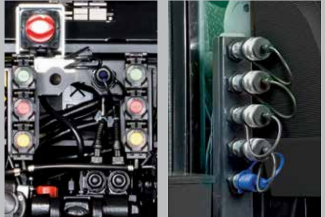
Maksymalnie po 3 obwoły układu hydraulicznego z tyłu oraz centralnie przy kabinie ciągnika. Powrót oleju oznaczony kolorem niebieskim.
