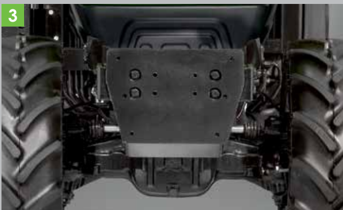
3 Płyta na narzędzia montowana z przodu ciągnika.
