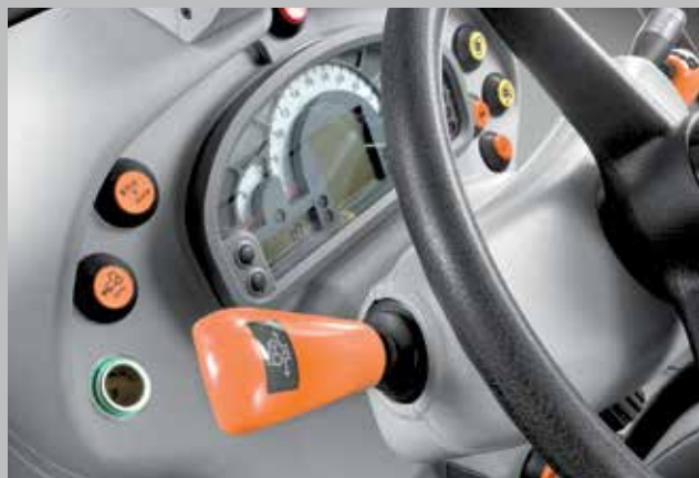
Powershuttle. Zmiana kierunku jazdy w trakcie jazdy. Ergonomiczna, krótka dźwignia rewersu elektro-hydraulicznego umieszczona pod kołem kierownicy.
