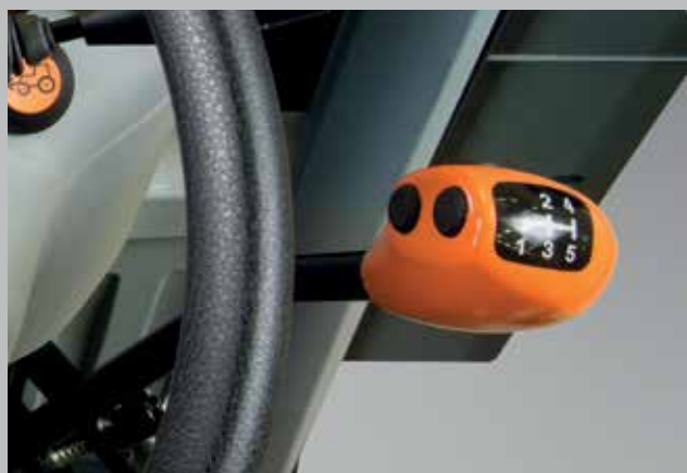
PowerShift. Skrzynia z półbiegami pod obciążeniem. Przyciski zmiany półbiegów i sprzęgła Comfort Clutch na dźwigni zmiany biegów.
