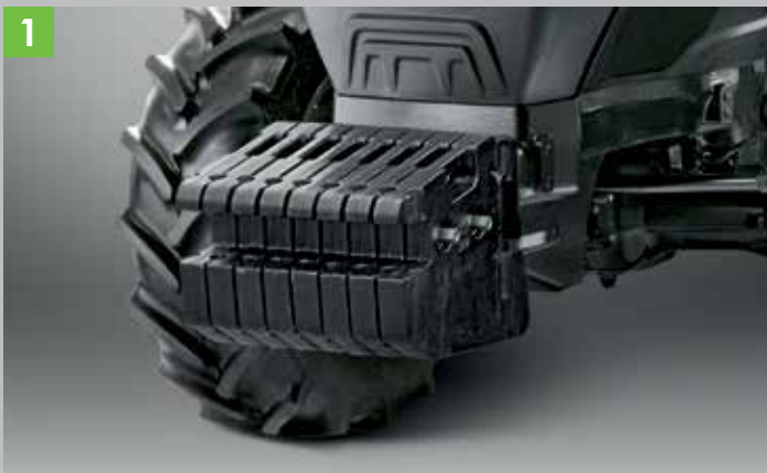
1 Różne wersje obciążników i balasty do podnośnika przedniego.
