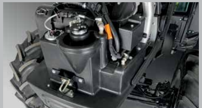
Zbiornik paliwa zabudowany w przedniej części komory silnika może być napełniany bez otwierania maski silnika dzięki dodatkowej pokrywie z przodu ciągnika.
