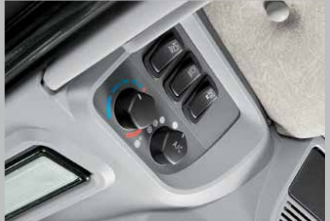
Prosty w obsłudze panel sterowania układem klimatyzacji z czytelnie oznaczonymi pokrętkami umieszczono pod dachem kabiny.
