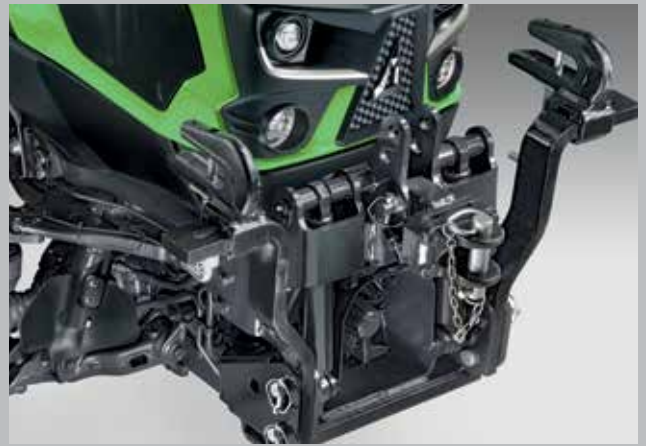
Opcjonalny, kompaktowy podnośnik przedni. Składane ramiona, zwarta konstrukcja, wysoki udźwig, precyzyjne sterowanie.
