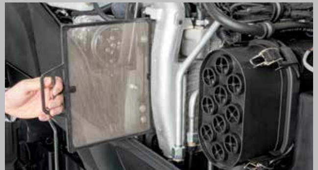
Wydajność silnika wspiera zaprojektowany od podstaw pakiet chłodnic. Zwiększono też przepływ powietrza przez filtr PowerCore.
