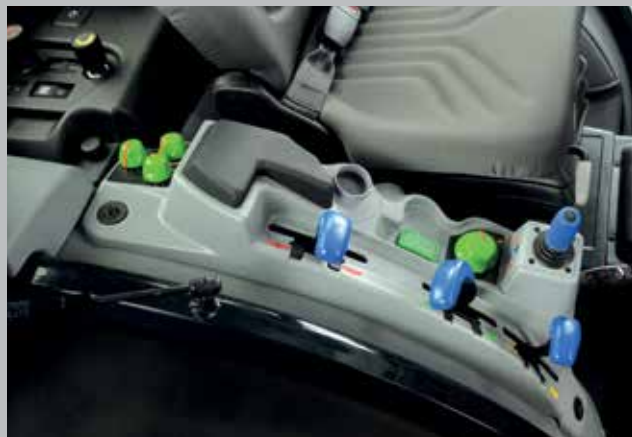
Dźwignie sterowania układem hydraulicznym oraz pokrętła do obsługi tylnego podnośnika umieszczone tuż obok fotela operatora.
