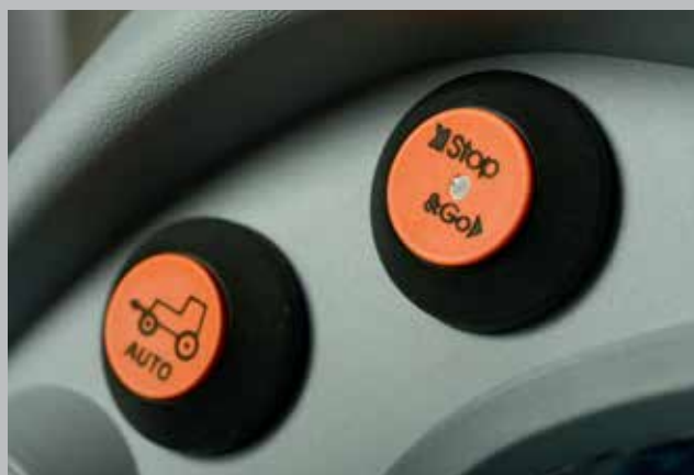
Stop&Go. Zatrzymanie ciągnika bez konieczności wciskania pedału sprzęgła w podłodze. Przycisk funkcji Stop&Go na desce rozdzielczej obok zegarów.
