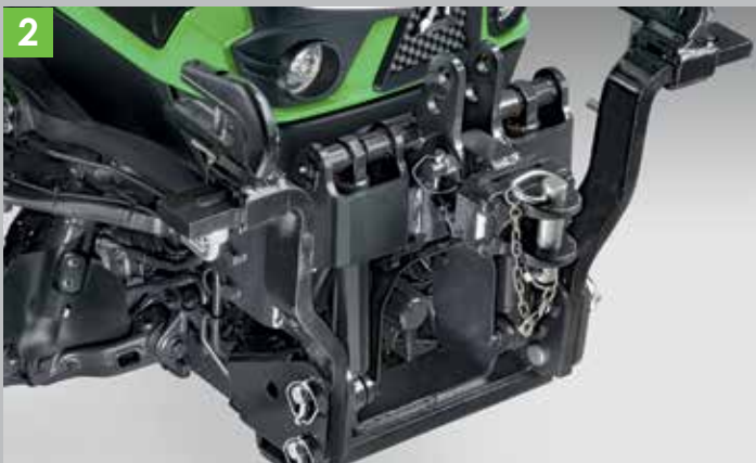
2 Układ hydrauliczny i podnośnik przedni z WOM.
